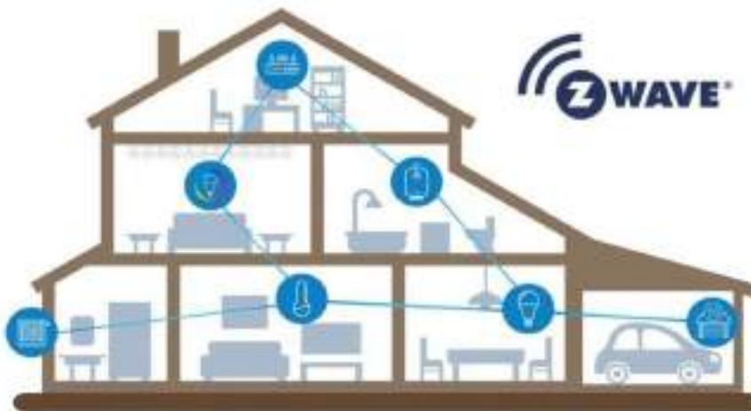
Figura 11. Topología de red Z-Wave
